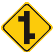
A-11b JUNÇÕES SUCESSIVAS CONTRÁRIAS 1ª À DIREITA
