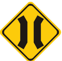
A-22 PONTE ESTREITA
