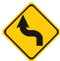
A-4a CURVA ACENTUADA EM "S" À ESQUERDA
