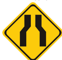
A-21a ESTREITAMENTO DE PISTA AO CENTRO
