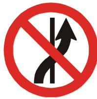
R-8a PROIBIDO MUDAR DE FAIXA OU PISTA DE TRÂNSITO DA ESQUERDA PARA A DIREITA
